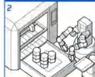
2 配送机器人到达各自取货点与分拣机器人协同工作。
